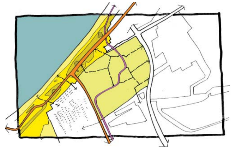
handhaaf de doorgaande routes in de randen, zorg voor een aantakend padenstelsel tussen de bouwvelden
