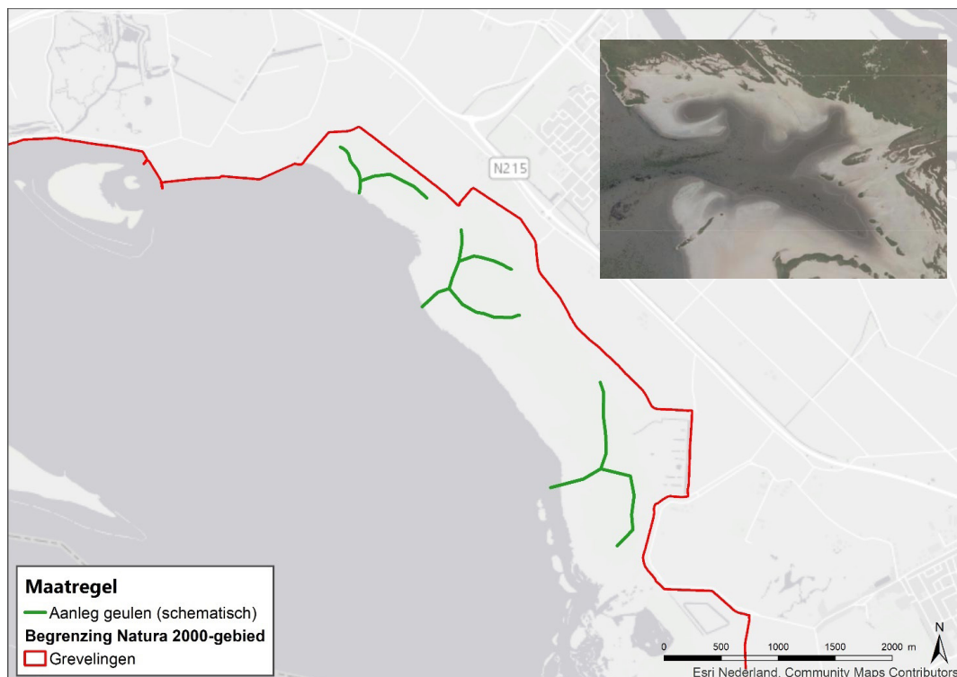
Figuur 5-6. Mogelijke ligging van de geulen in de Slikken van Flakkee noord (schematisch). Hierbij gaat het om de bredere delen van de geulen. Met rechtsboven een impressie van een huidige geul op de Slikken van Flakkee.
