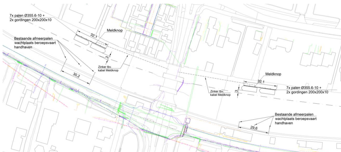
Figuur 1 – Oplossing Definitief Ontwerp wachtplaatsen noordelijke oever
