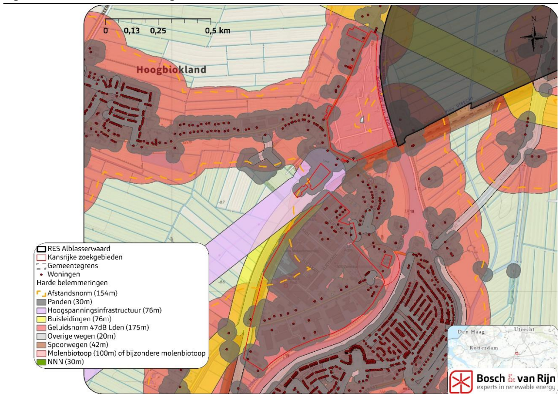
Figuur 37 Harde belemmeringen Vlietskade Arkel
