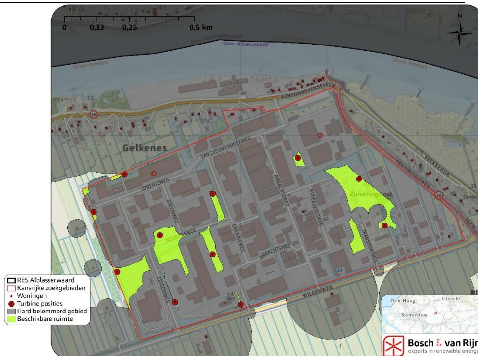
Figuur 8 Ingetekende turbineposities en technische ruimte op industrieterrein Gelkenes
