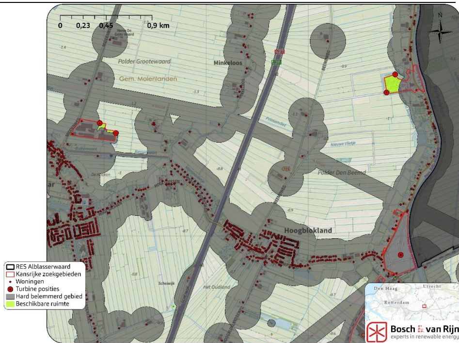
Figuur 10 Ingetekende turbineposities en technische ruimte Hoogblokland, de Vort Noordeloos en Arkel
