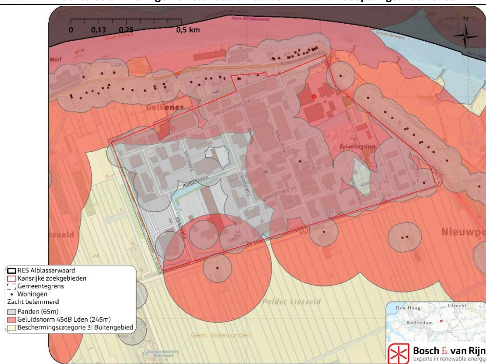
Figuur 32 Zachte belemmeringen en standaardwaarde windturbinebepalingen Gelkenes
