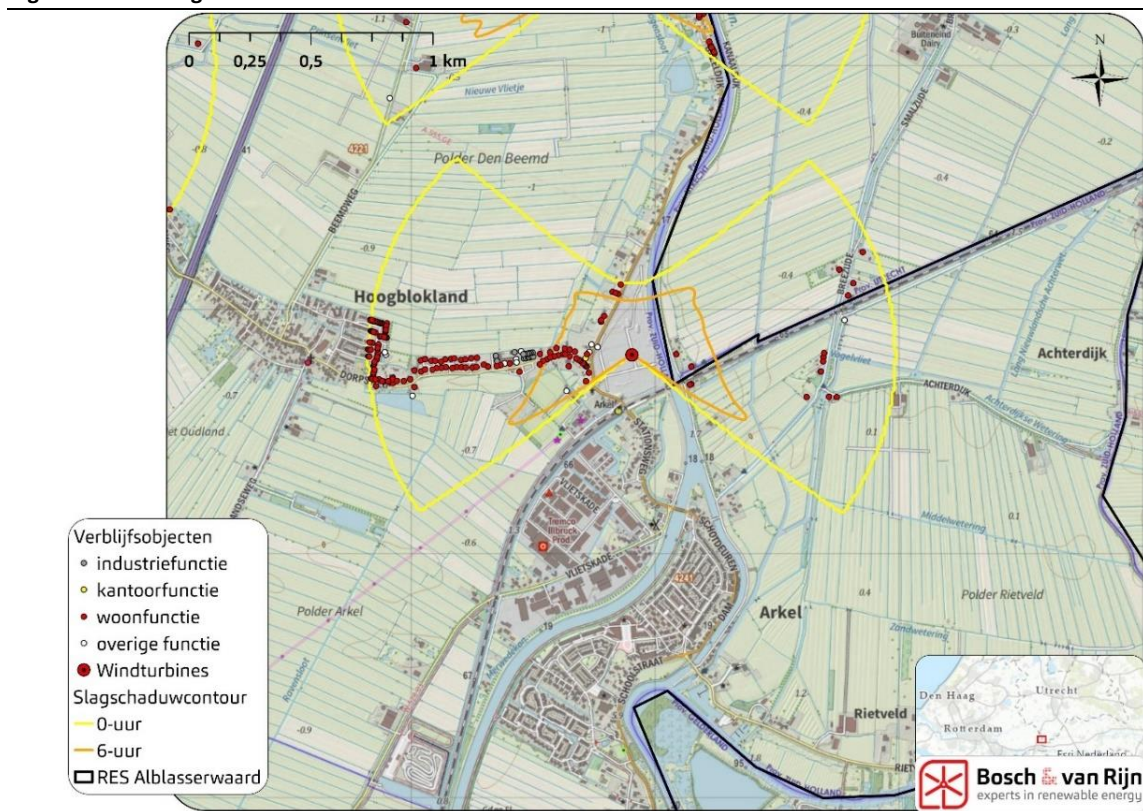
Figuur 54 Slagschaduwcontour Vlietskade Arkel
