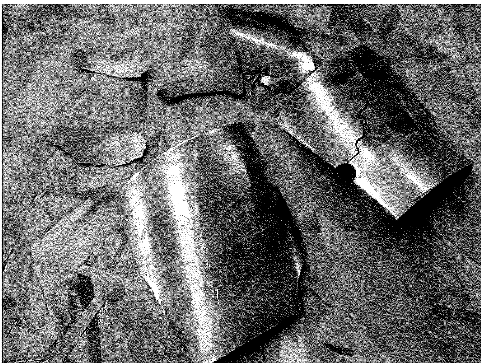
Afbrokkeling van het onderste lager vd.stuurknuppel. ( witmetaal ) oorzaak ?
