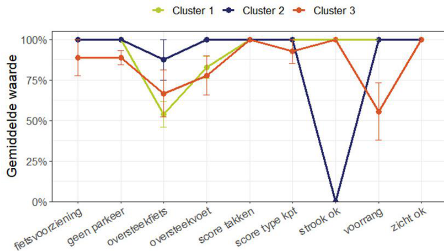
Afbeelding 3.11. Het gemiddelde percentage van de mate waarin rotondes op provinciale wegen binnen een cluster voldoen aan elk van de 9 veiligheidskenmerken. De verticale balk per punt geeft de foutenmarge aan; plus en min de standaardfout.
