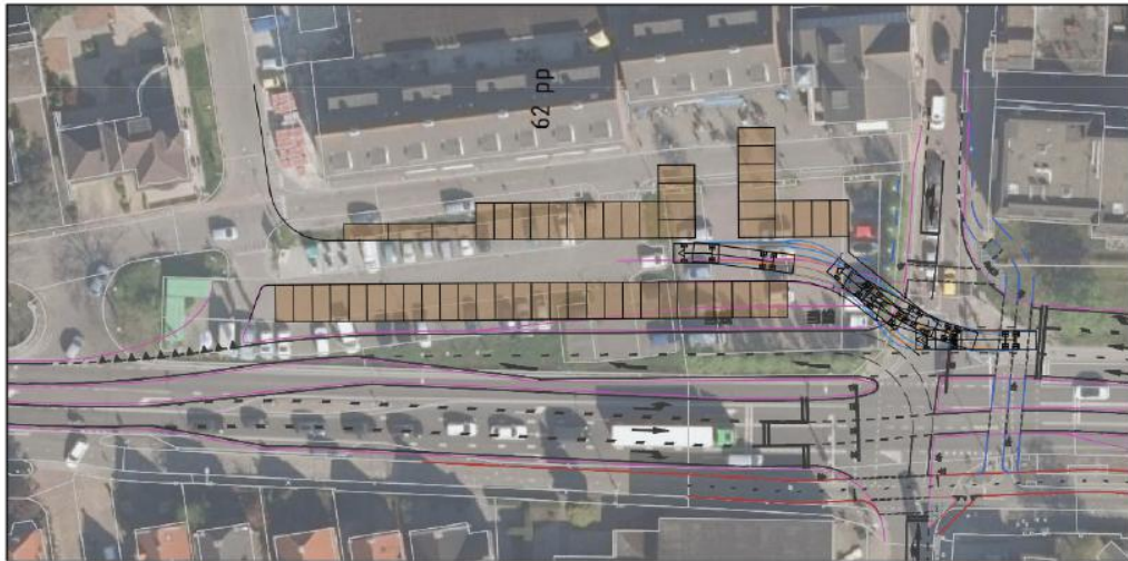
Figuur 4: Ontwerp gemeente zonder verplaatste bushalte, met doorgaande route over het p-terrein (bron: gemeente Alphen aan den Rijn)
