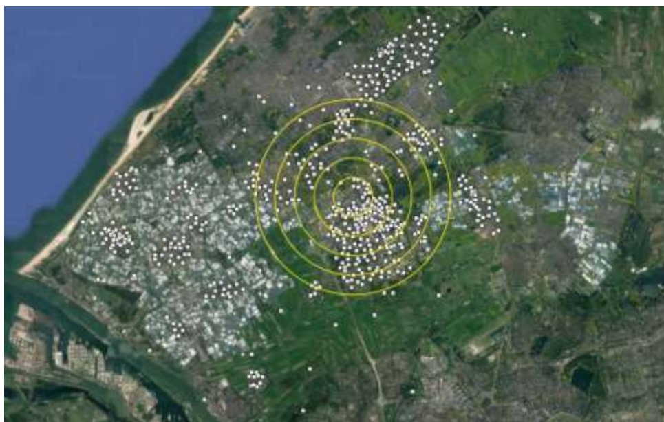
Figuur 17 De 700 Peilbuizen rond de onttrekking waar elk uur de grondwaterstand wordt gemeten.
