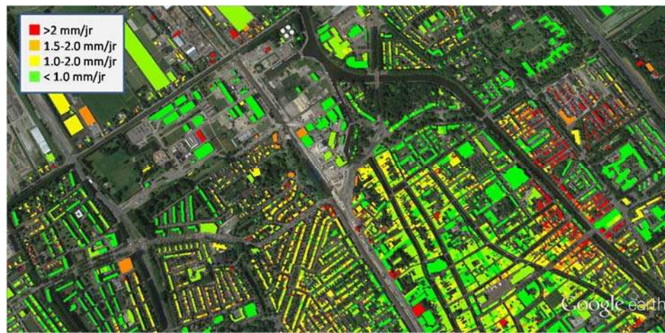
Figuur 6-7 Zakkende panden in en om de DSM-onttrekking
