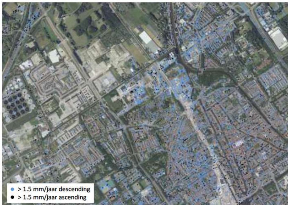
Figuur 32 Locaties in de omgeving van Delft waar het maaiveld de afgelopen 2 jaar met 1.5 mm per jaar is gestegen. De zwarte punten zijn van de opgaande baan van de TerraSAR-X satelliet en de blauwe van de neergaande baan
