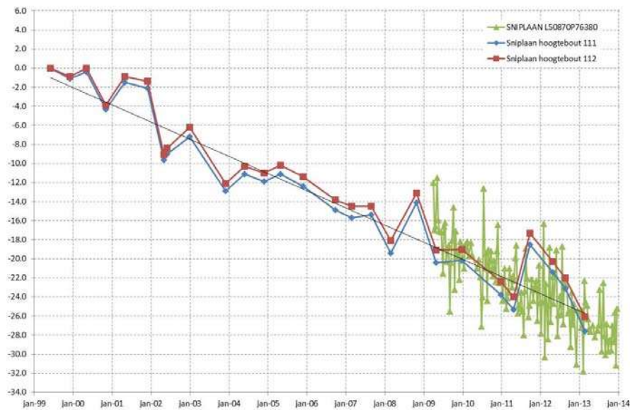
Figuur 5-6 De 2 hoogtebouten in de Sniplaan 1.8 mm per jaar gezakt.
