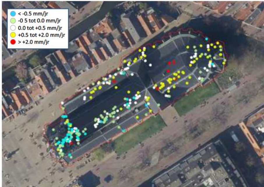
Figuur 37 De Nieuwe Kerk in Delft. Enkel bij de toren wijkt de deformatie iets af van het omringende maaiveld en het schip van de kerk.
