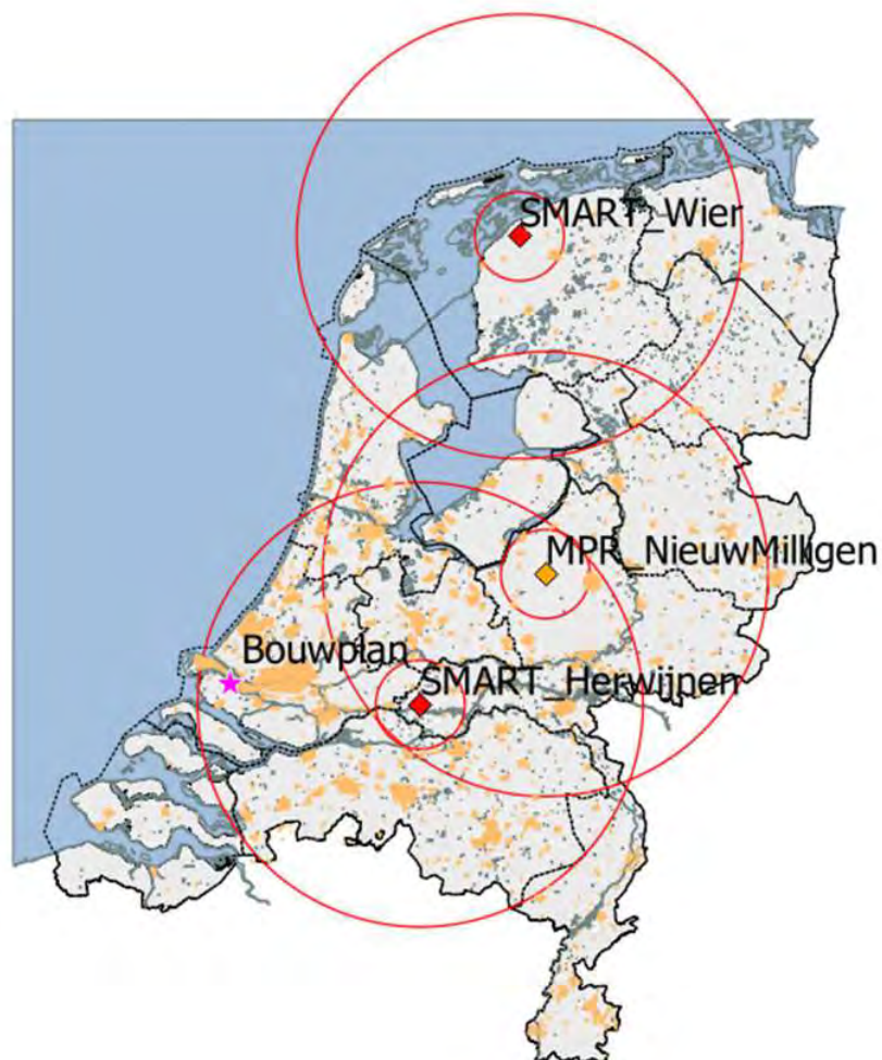
Figuur 4 Locaties van de nieuwe SMART-L EWC GB gevechtsleidingsradars (rode ruit) en de bestaande MPR (oranje ruit) met daaromheen de 15 en 75 km cirkels. De oranje vlakken zijn de in de AHN-1 gedefinieerde stedelijke gebieden. De ligging van het te toetsen bouwplan is aangegeven met een roze ster.
