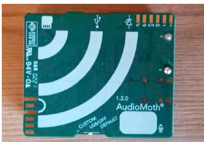
Figuur 5.4 Audiomoth dit type apparaat is gebruikt in dit onderzoek om aanvullende informatie te verzamelen over migratie van vleermuizen over het plangebied.
