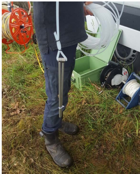
Afbeelding 1. Constructie van twee rvs steunpoten van een doorstroomcel, bevestigd aan het uiteinde van de bemonsteringsslang, om deze tot in het peilbuisfilter te laten zakken bij bemonstering met de slangenpomp.
