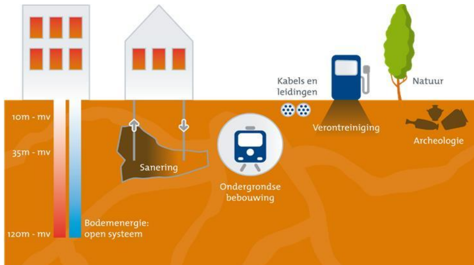
Figuur 1.2 | Overzicht ondergrondse functies
