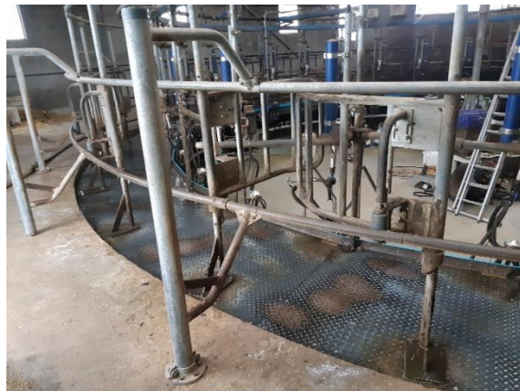
Carrousel met op voorzijde constructie buitenring
