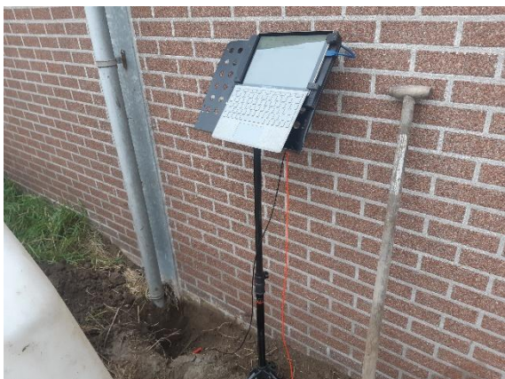
Meting spanning op veiligheidsaarding
