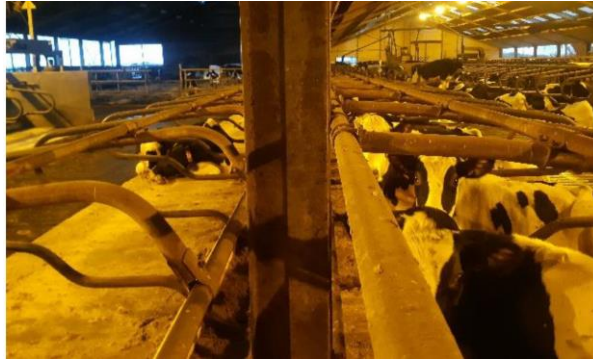
Figuur 8. Ligboxen verbonden met staalconstructie
