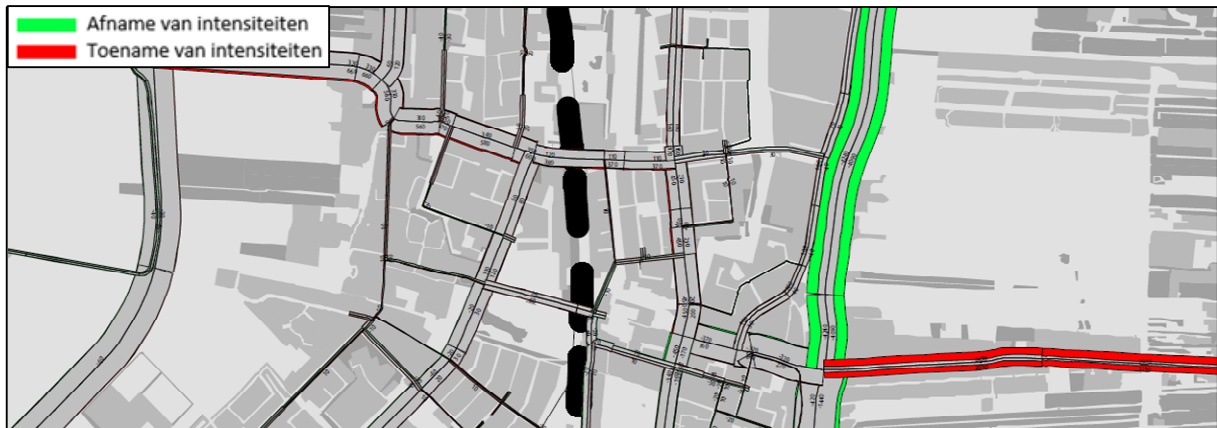
Figuur 33, Verkeerseffecten W16 en W19 in Waddinxveen (Uitsnede vanuit verkeersmodel). Zwarte stippellijn is de spoorlijn.
