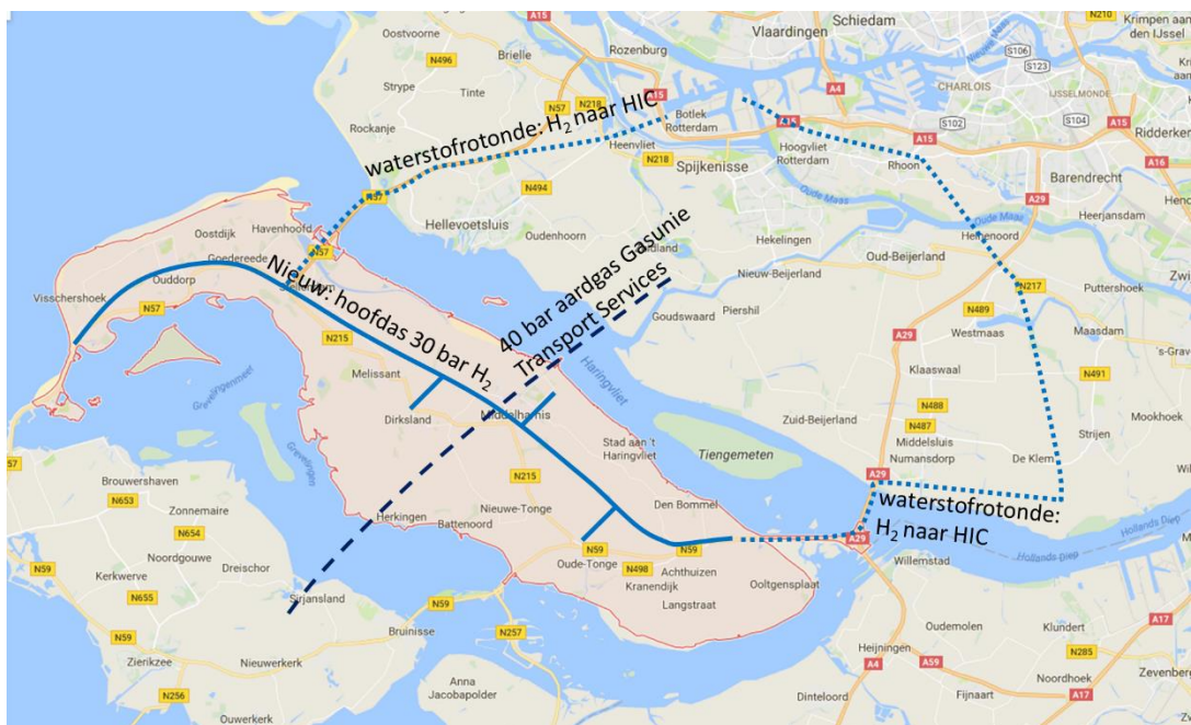
Figuur 1: schets mogelijk tracé waterstofpijplijn over eiland en naar het Haven Industrieel Complex
