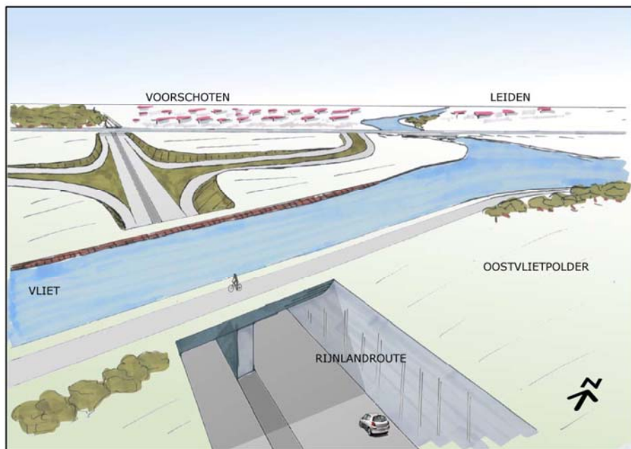
Figuur 28: open tunnel met aansluiting Voorschoterweg
