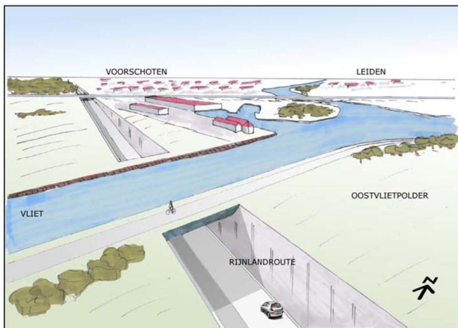
Figuur 19: open tunnelbak
