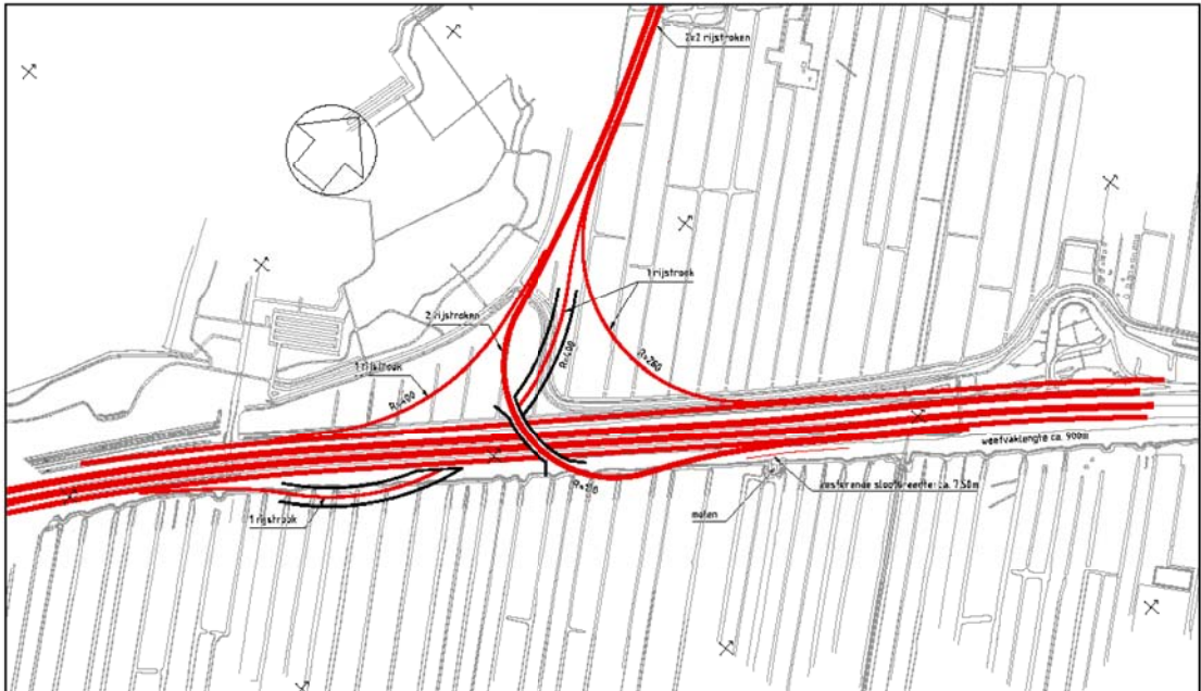
Knooppunt A4 Halve ster zuidelijk gedeeltelijk verdiept
