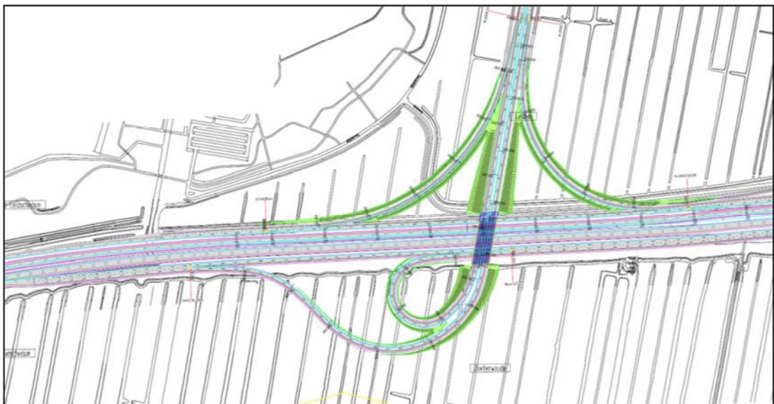
Knooppunt A4 ZNB Optimaal Trompet aansluiting bovenlangs
