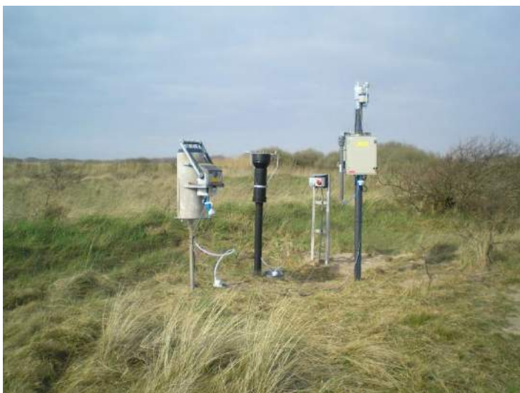
Figuur 2.1: Voorbeeld van een meetopstelling met van links naar rechts, een “wet-only” regen vanger, een bulk depositievanger, de 220 V aansluiting, de paal met meteostation (bovenop) en deltadenuder (kast in het midden, zie hieronder)
