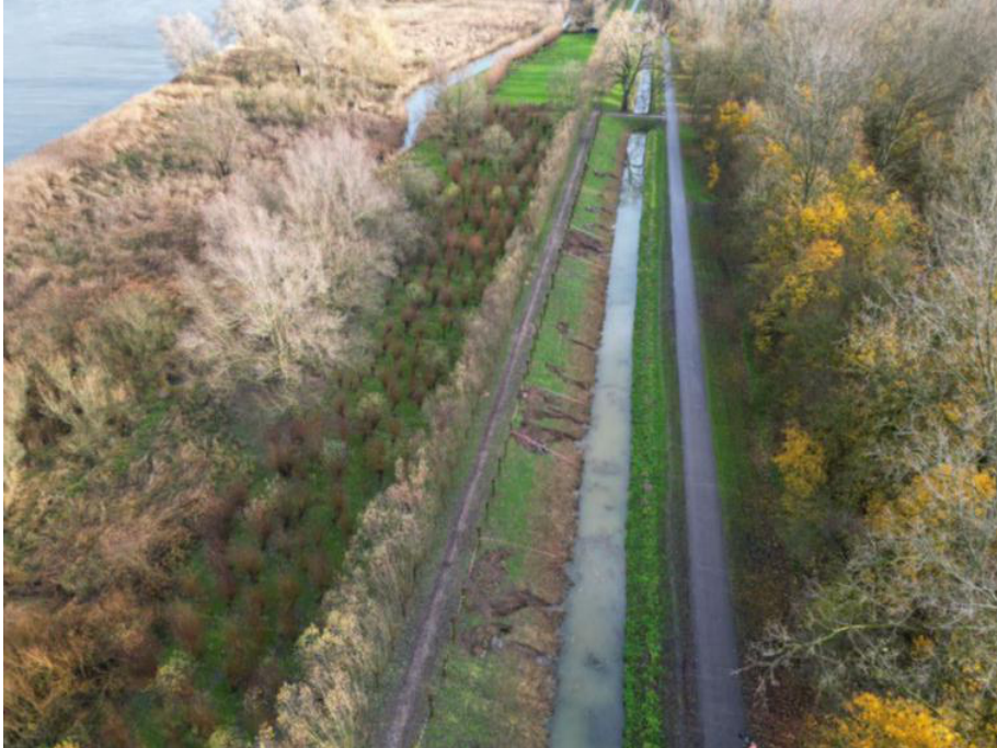
Afbeelding 4.1: diverse graafschadelocaties in beeld gebracht dijk Merwede bij Dordrecht: in totaal 17 holen in de kering aangetroffen over een lengte van 300 meter.
