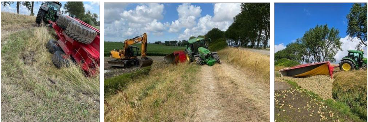
Afbeelding 4.4: gegraven hol in landbouwdam in Herkingen met kantelende tractor met aanhangwagen tot gevolg.
