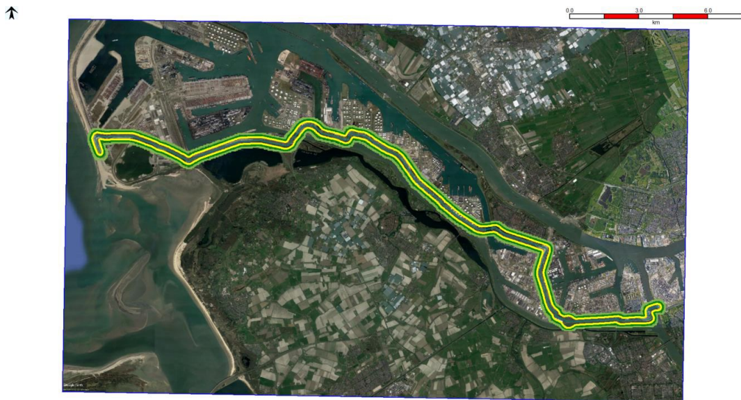
Figuur 1: De berekende PR-contouren van de waterstofleiding.
