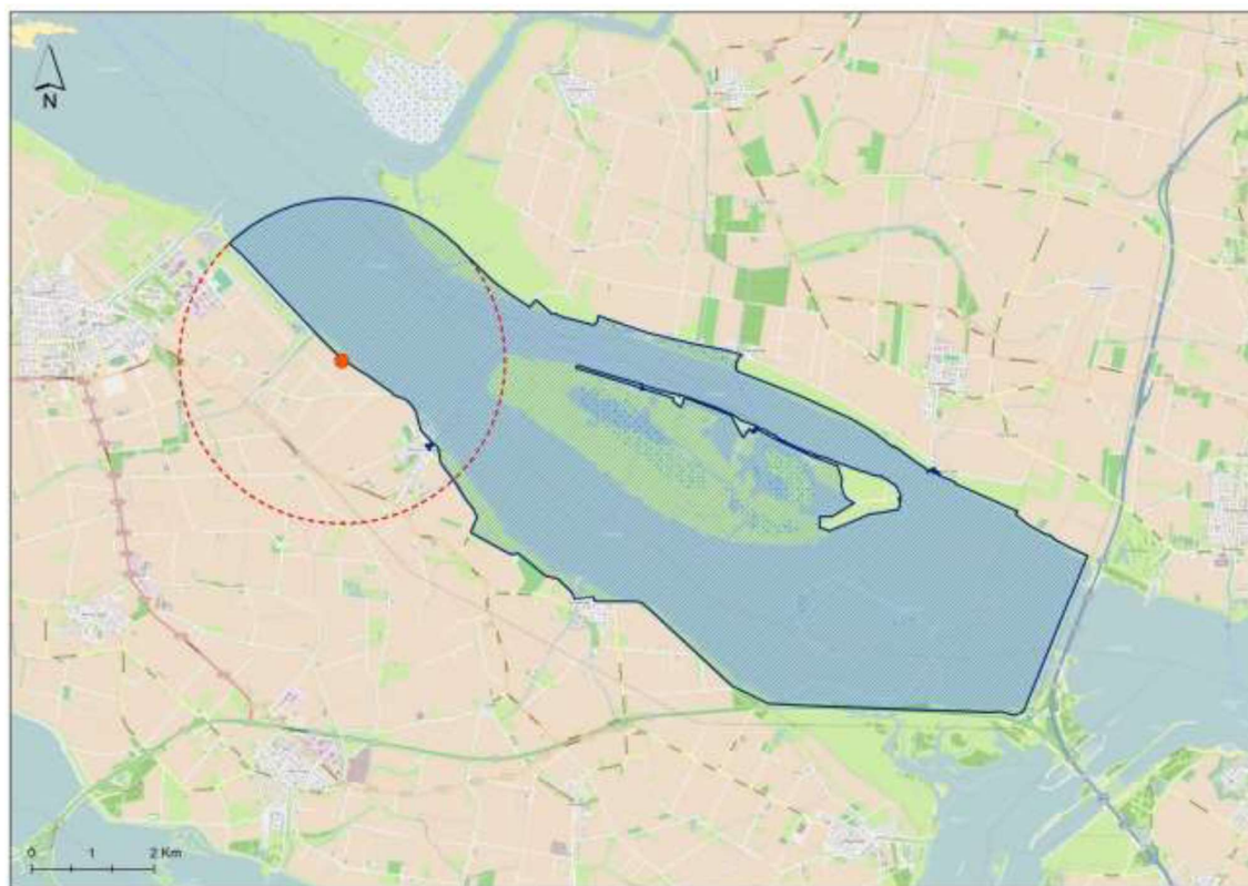
Figuur 2 De nieuwe locatie van het innamepunt Haringvliet en de bijbehorende 6-uurs beschermingszone. (Bron: RoyalHaskoning-DHV, 2015)
