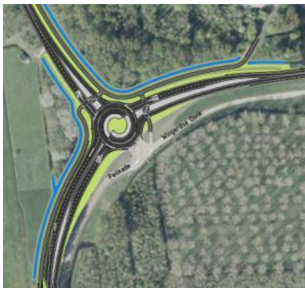
Figuur 9: Screenshot ontwerp meerstrooksrotonde N214-N481, zie bijlage D voor volledige visualisatie
