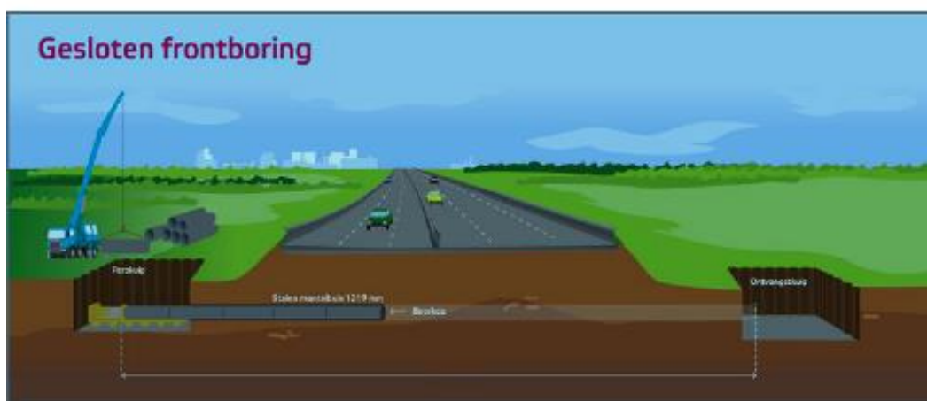
Figuur 2-4 Schematische weergave GFT boring
