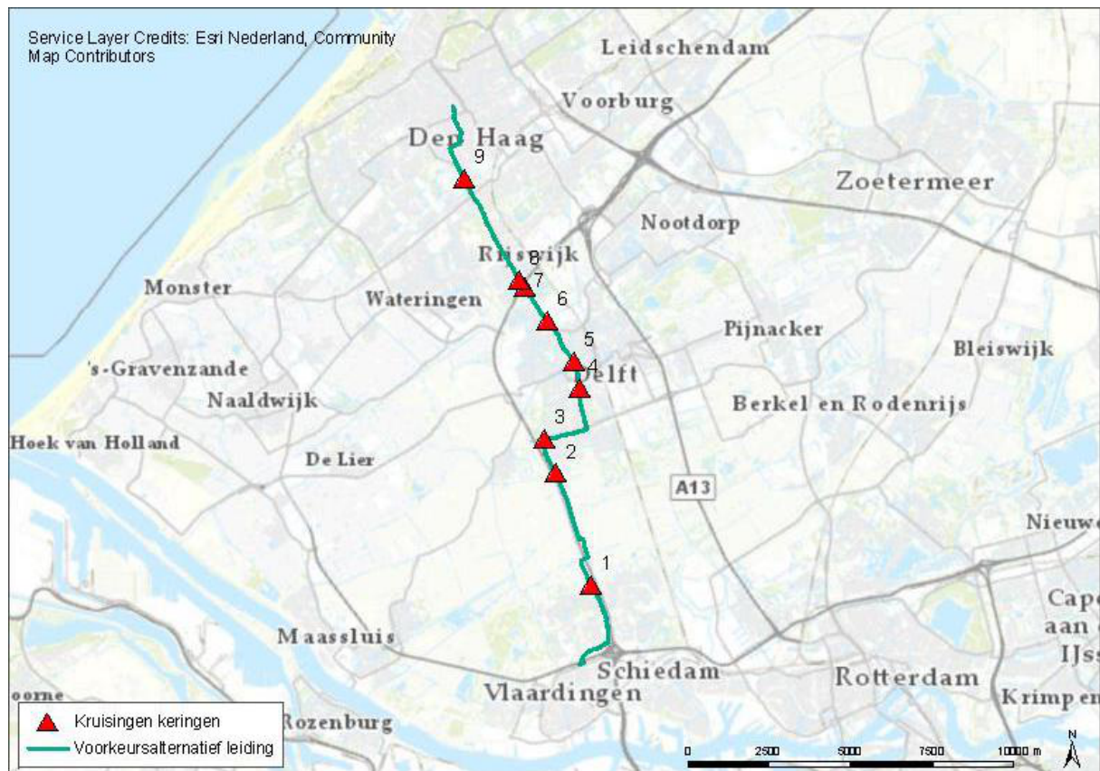
Figuur 1 Kruising van de warmtetransportleiding met de regionale keringen (Bron: Legger Hoogheemraadschap van Delfland)
