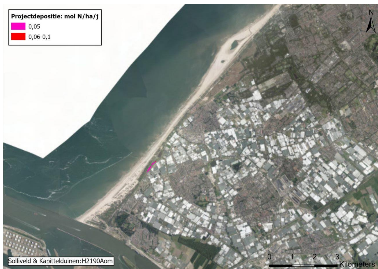
Figuur 52 Toename stikstofdepositie op habitattype H2190Aom Vochtige duinvalleien (open water) als gevolg van de aanleg van Warmtelinq.
