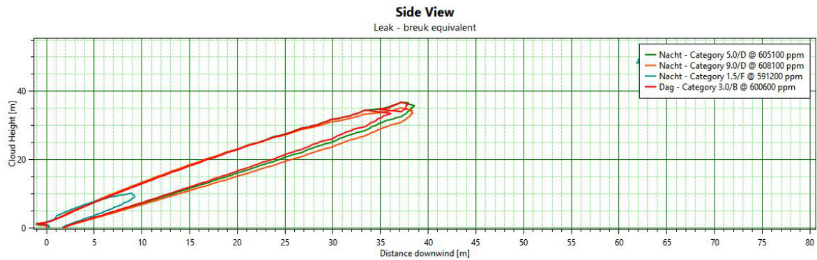
Figuur 7-12 Zijaanzicht 45 graden breuk
