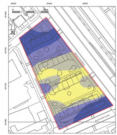
Plangebied Bovenkant duin duin lager dan -2,20 m -NAP 2,20 tot 1,75 m -NAP 1,75 tot 1,30 m -NAP duin hoger dan 1,30 m -NAP
