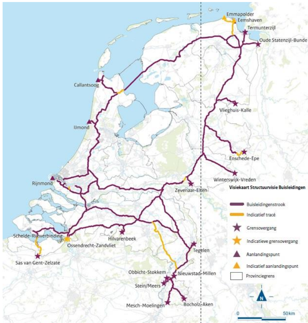
Figuur 5-2 - Overzichtskartaalstructuurvisie Buisleidingen
