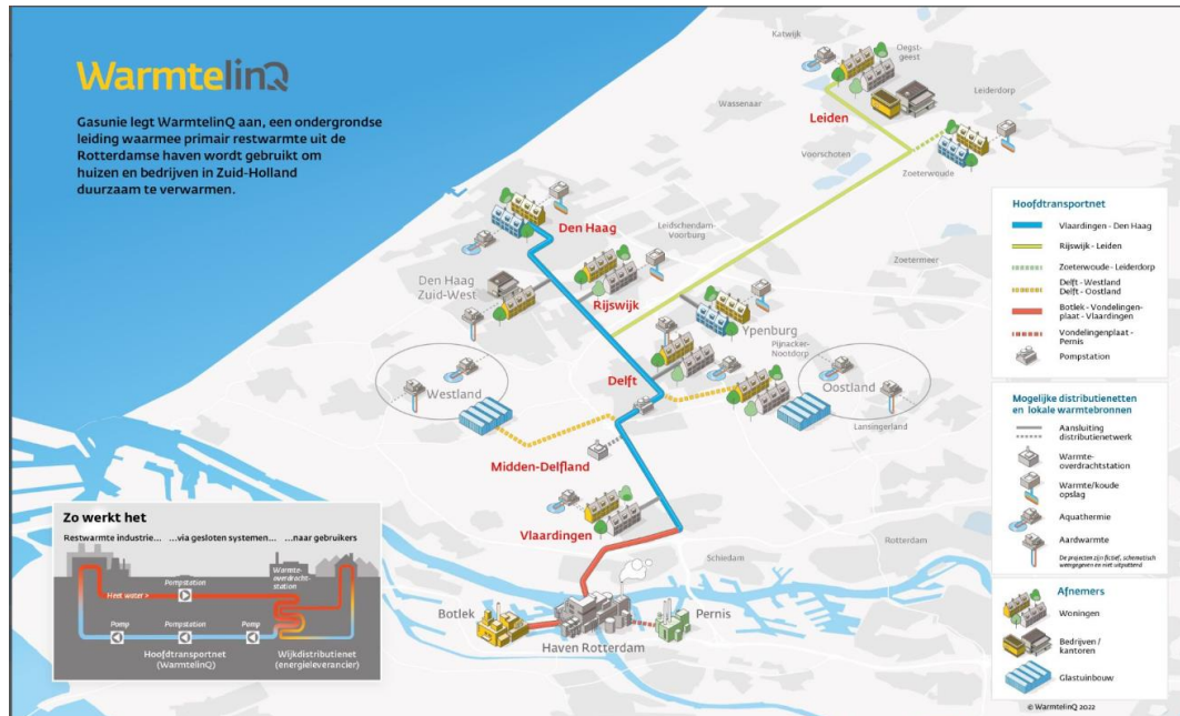
Figuur 5-2 - Overzicht van leidingen binnen WarmtelinQ
