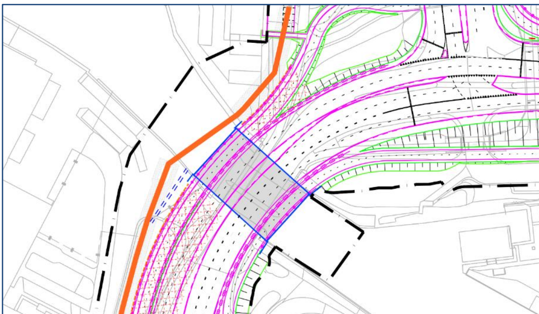
Verschoven Trekvljetbrug met in oranje het stamriool
