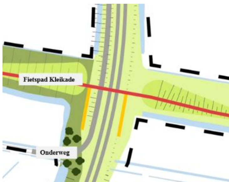
Figuur 3.14 Schets van situatie rondom de dijkcoupure in de Kleidijk (bovenaanzicht)
