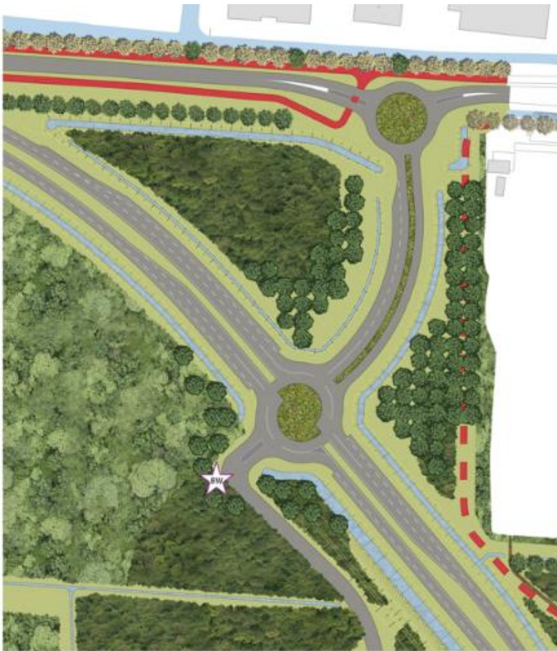
Figuur 3.16 Locatie van de turborotonde in de Verlengde Bentwoudlaan en enkelstrookstrotonde in de Hoogeveenseweg (bron: Landschapsplan (Verlengde) Bentwoudlaan)
