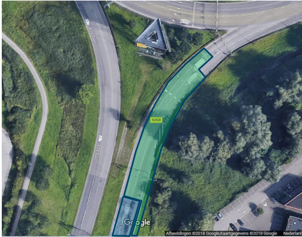
Figuur 7: Voorstart voor vrachtwagens op knooppunt lunetten. In blauw de drie stroken hoofdrijbaan, in groen de voorstart voor vrachtverkeer en bussen. Hoofdrijbaan en vrachtstrook hebben afwisselend groen licht waardoor het groene vak altijd opgevuld wordt. (bron: Google Maps)
