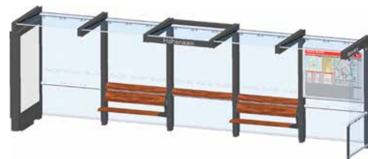
neutrale wachtruimte 1,55 m diep, zonder voorwand, met reclame display in zijwand
