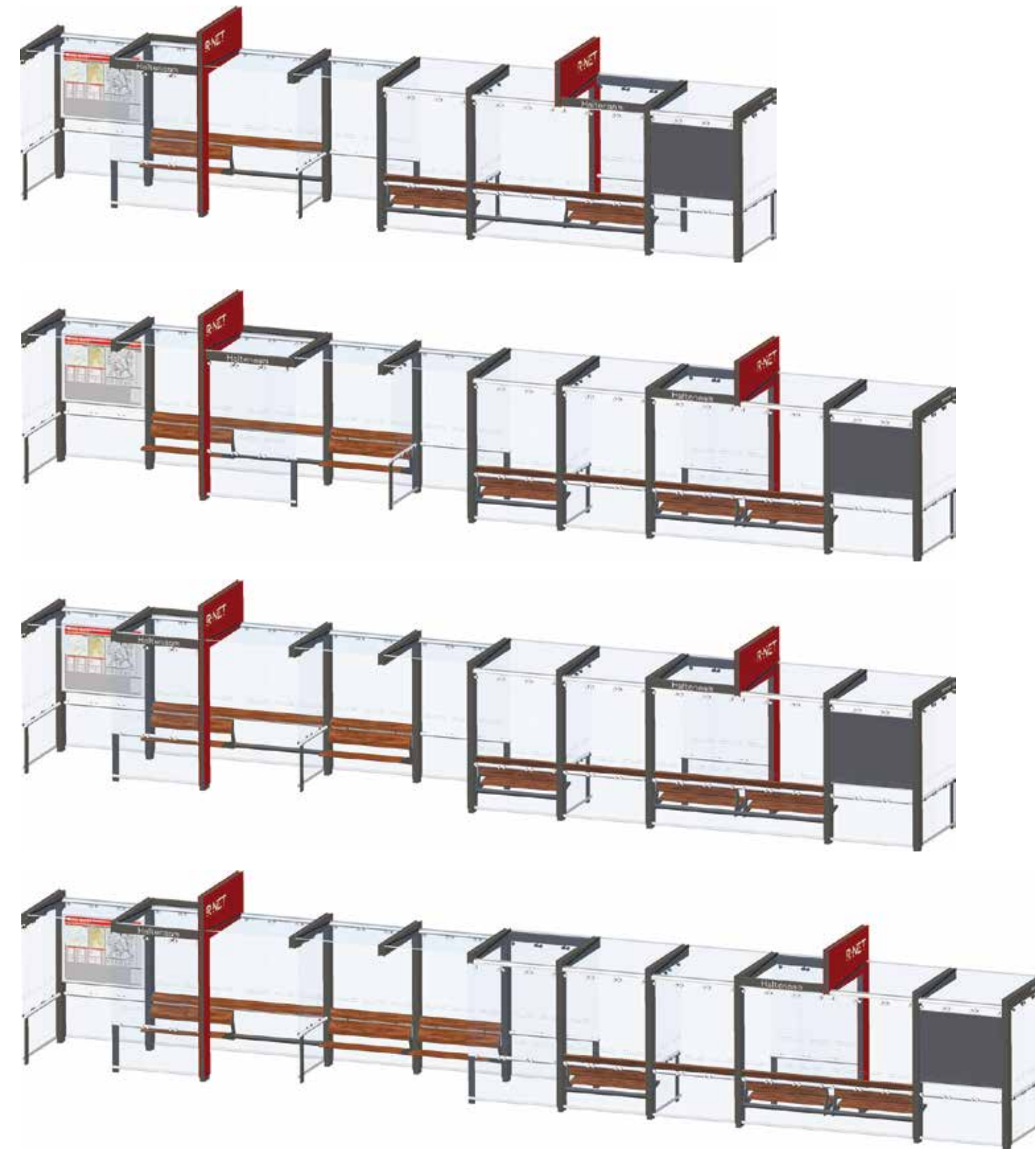
R-net wachruimtes voor eilandperrons, 1,80 m diep met openingen naar beide lange zijden
