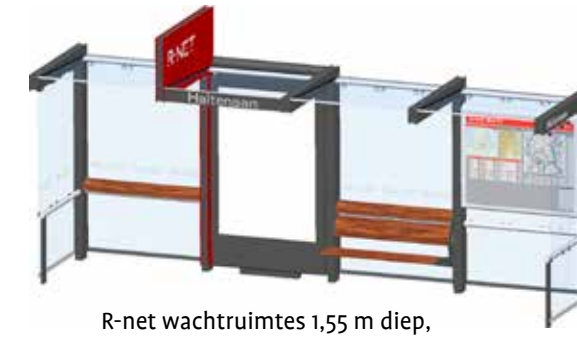
R-net wachruimtes 1,55 m diep, zonder voorwand, met reclame display in achterwand
