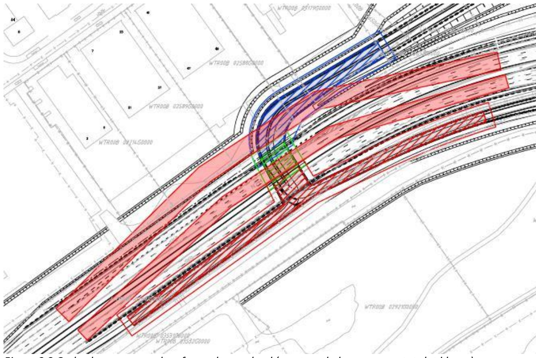
Figuur 3.8 Onderdoorgang wordt gefaseerd aangelegd (eerst rood, dan groen en tot slot blauw).
