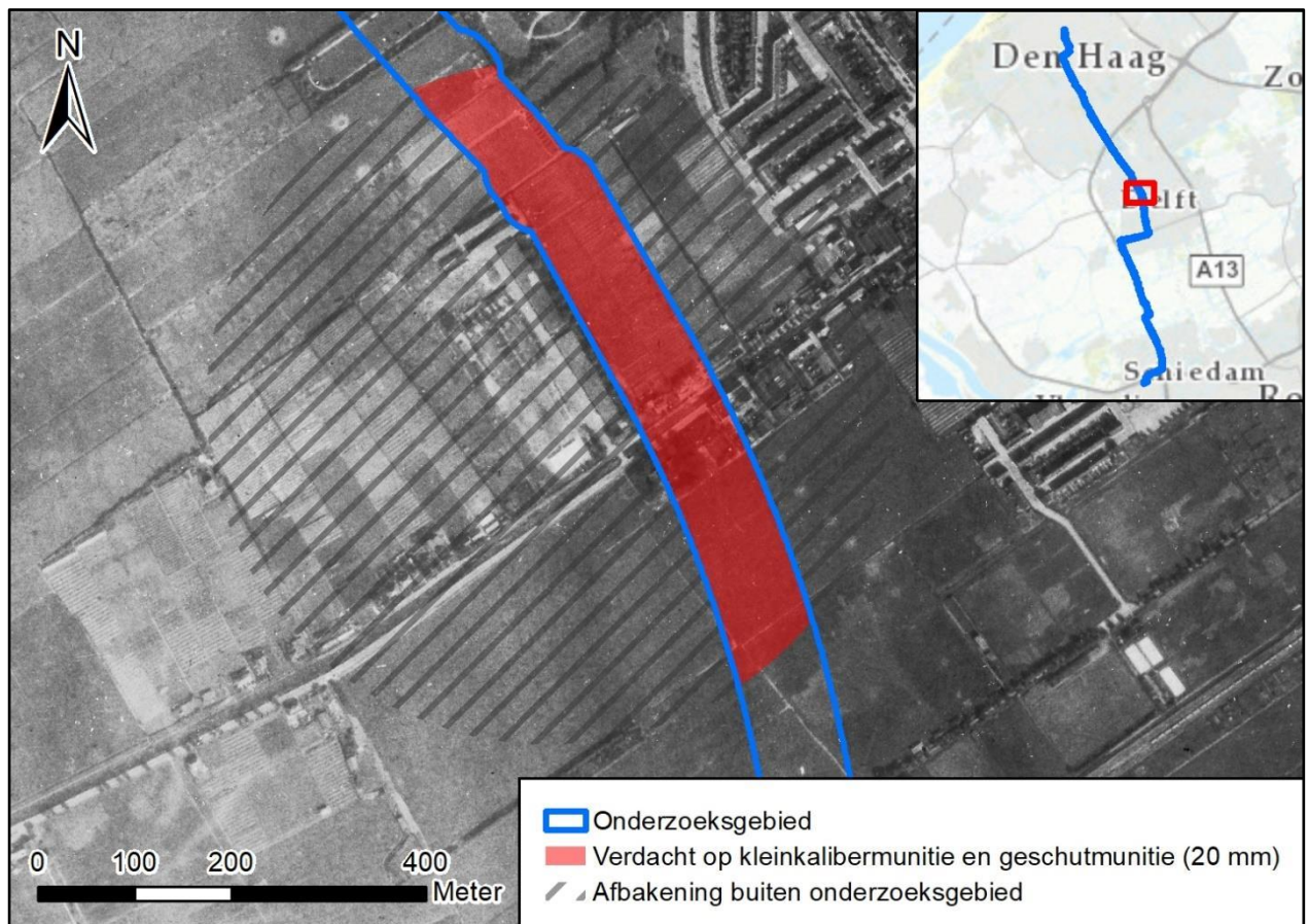
Figuur 27. Tijdens de Britse luchtaanval in de nacht van 20-21 juli 1941 vond bij de Kogelgieterij een massa-explosie plaats, waarbij enorme hoeveelheden CE werden weggeslingerd. Een deel van het onderzoeksgebied is verdacht op kleinkalibermunitie en geschutmunitie van 20 mm. De methode van afbakening wordt toegelicht in paragraaf 5.8.
